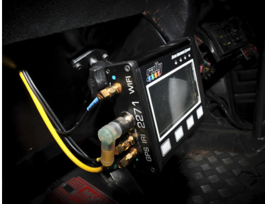
Bild 3: Standardinstallation Gerät+Antenne in klarer / ungehinderter Sicht
